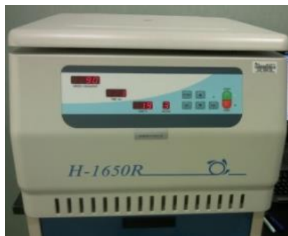
Figura 6. Centrífuga refrigerada para precipitación de analitos.
