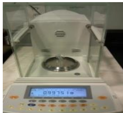
Figura 5. Balanza analítica de alta precisión (por ejemplo: 230 g ± 0,01 mg) para preparación gravimétrica ; pesado de muestras y/o reactivos.
