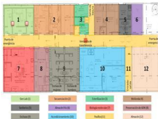
Figura 3. Ejemplo del diseño de un laboratorio de 390 m 2 aproximadamente, con áreas de trabajo separadas para el análisis de OGM. Las áreas y las medidas de superficie de cada una son: 1. Gene Lab 24 m 2 , 2. Secuenciación 24 m 2 , 3. Esterilización con una área de 4 m 2 , 4. Molienda 32 m 2 , 5.
